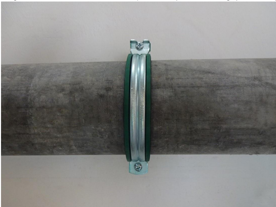
Bild 2: Messung 4: KSB2 Zweischrauben-Rohrschelle, 4" (108 - 115 mm), mit EPDM-Einlage (23 x 4,20 mm)
